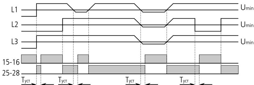
При однофазном снижении напряжения  $U_{\min}$
