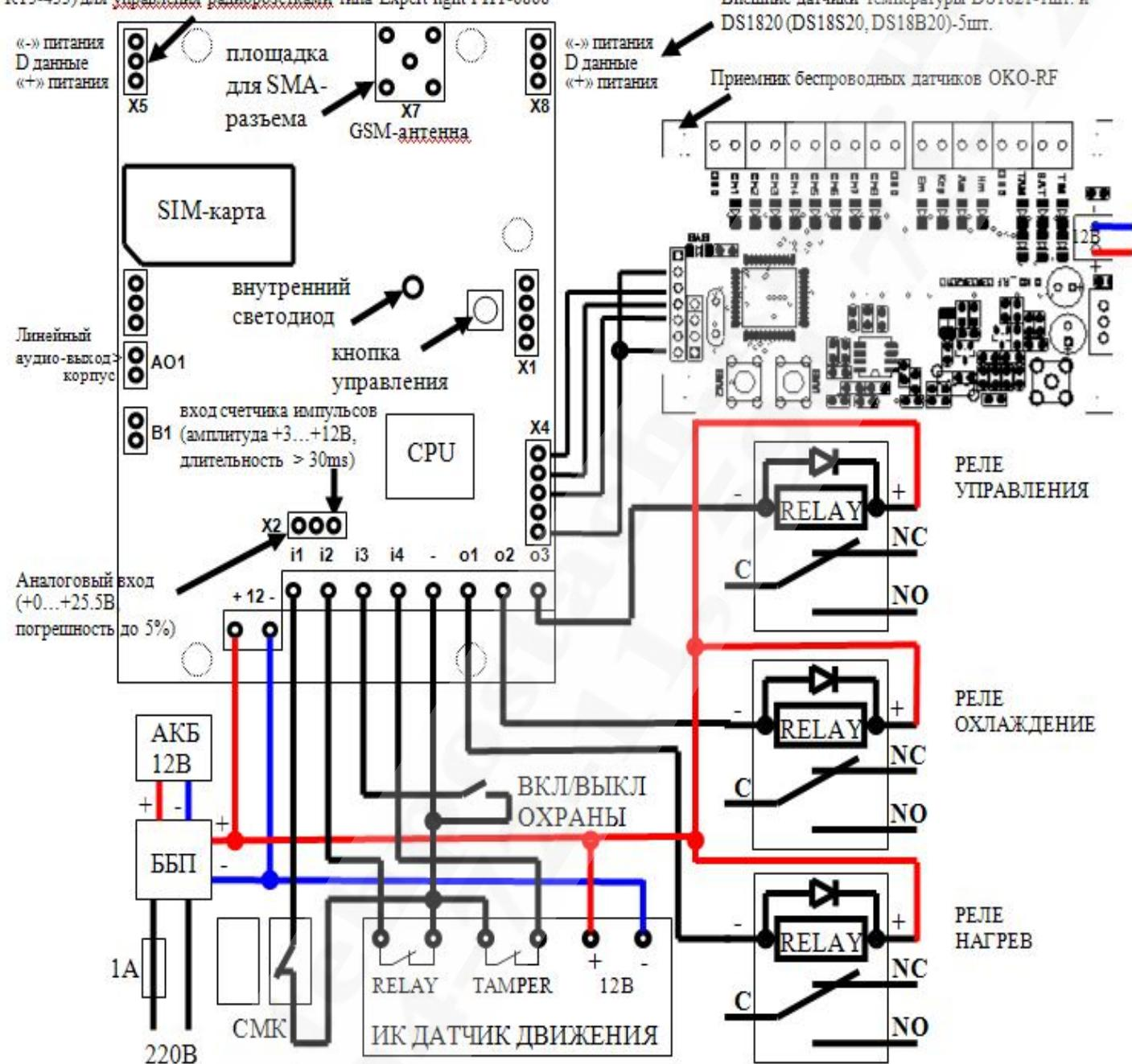
**НИЖЕ ОПИСАН ПРИМЕР САМОГО ПРОСТОГО ИСПОЛЬЗОВАНИЯ ПРИБОРА для подогрева объекта:**
