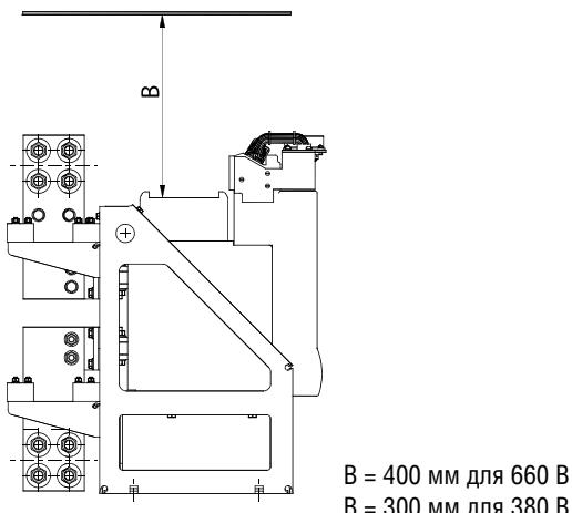
**Зона ионизации автоматического выключателя
