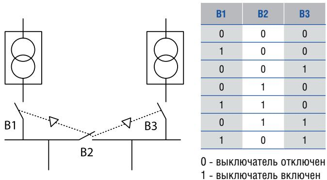
В данной схеме используются три выключателя с двойной механической блокировкой для выключателя B2. Выключатели B1 и B3 подают электроэнергию от двух силовых трансформаторов. Для такой системы возможны шесть комбинаций состояний выключателей.
