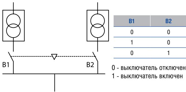
Выключатель B1 используется для подачи основного питания, а выключатель B2 - для подачи аварийного питания от генератора при отключении основного. В данной конфигурации оба выключателя могут быть одновременно отключены, но включенным может быть только один выключатель.
