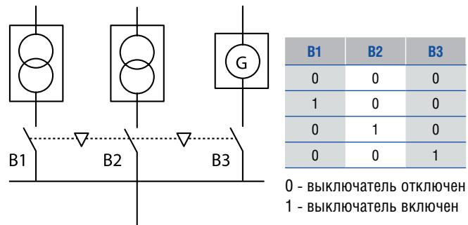
Три выключателя подключены к общейшине. B1 и B2 подают электроэнергию от двух силовых трансформаторов, а B3 - от электрогенератора (аварийное питание). В данной конфигурации все три выключателя могут быть одновременно отключены, но находиться под нагрузкой может только один аппарат.
