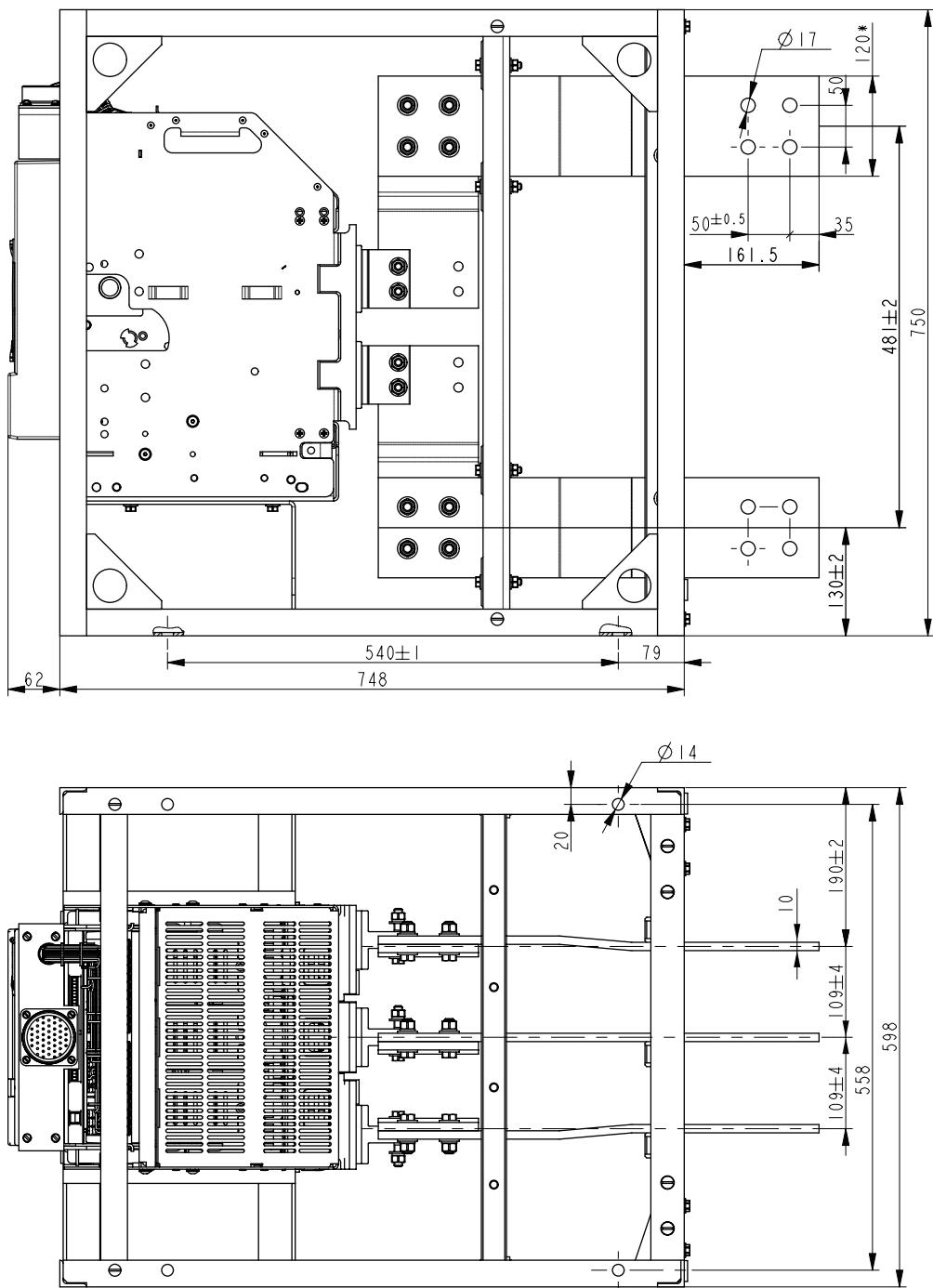
Общий вид и габаритные размеры выключателя
