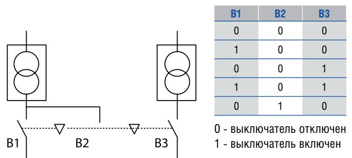
В данной схеме тоже используются три выключателя с двойной механической блокировкой для выключателя B2, которая организована иначе, чем в предыдущем случае, и поэтому обеспечивает четыре комбинации состояний выключателей. Выключатели B1 и B3 подают электроэнергию из двух независимых электросетей. Выключатель B2 используется для подачи питания в приоритетные цепи в случае аварии.
