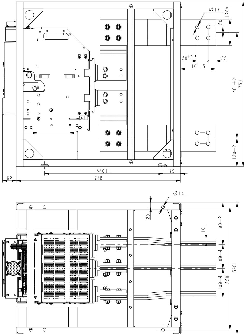
**Общий вид и габаритные размеры выключателя****«Электрон 340В Про»**
