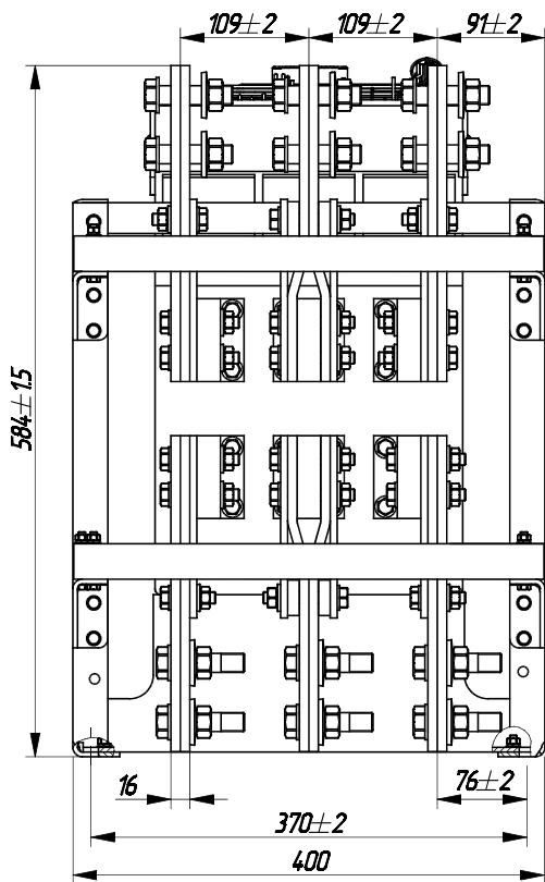
Общий вид и габаритные размеры выключателя
