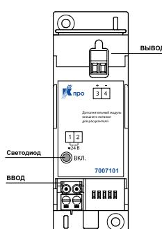
Устройство представляет собой преобразователь напряжения со входом  $\sim/-24 \text{ В}$  и предназначено для использования с автоматическими выключателями серии Протон. Ток на выходе преобразователя составляет до  $250 \text{ mA}$ . Зеленый светодиод указывает, что преобразователь включен и присутствует выходное напряжение.
