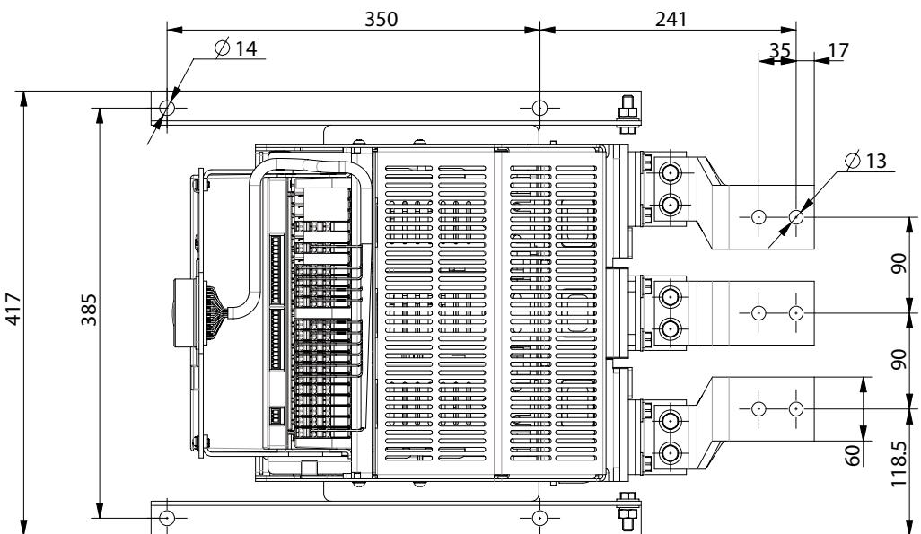
**Общий вид и габаритные размеры выключателя****«Электрон Э16В Про», «Электрон Э25В Про»**
